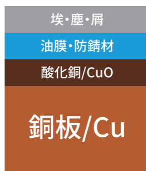
銅板上の汚れの断面図
